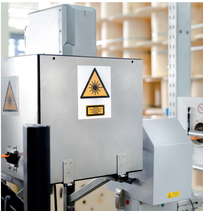
Laserbeschriftung von Hochvoltleitungen
